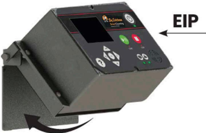
4. Conecte la cámara y el cable de internet en los casquillos previstos para ello de la unidad EIP. Conecte el cable de corriente a un enchufe con toma a tierra.
